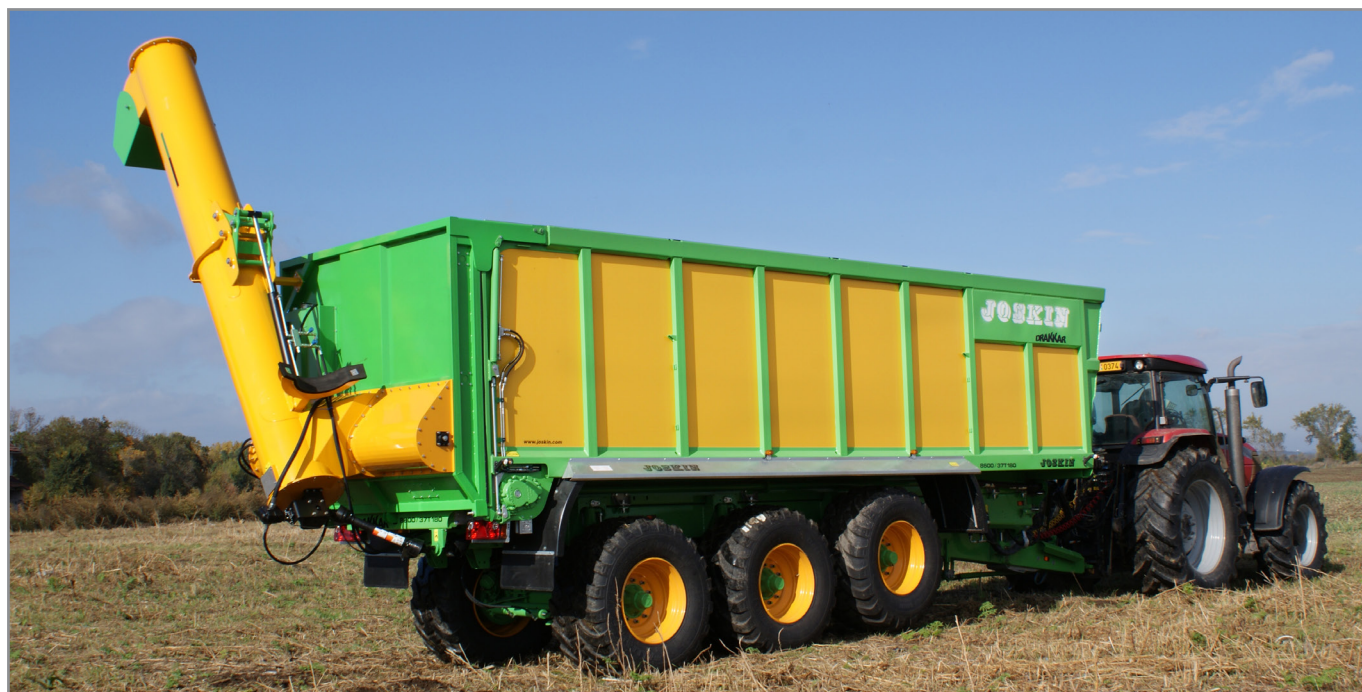
DRAKKAR ze ślimakowym urządzeniem przeładunkowym i dynamicznym systemem ważenia umożliwia dostosowanie się do obowiązujących przepisów podczas wyładunku do przyczepy.
